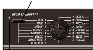
...se determina si el botón va a seleccionar valores prefijados (REFLEXION...FRACTAL), o registros (1...16)
